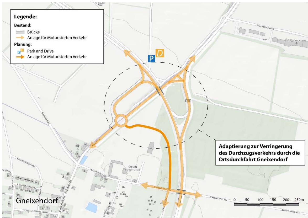
Abbildung 34: Adaptierung der AST Gneixendorf Nord, Anbindung Fidelio-Straße und Errichtung einer „P&D Anlage“
